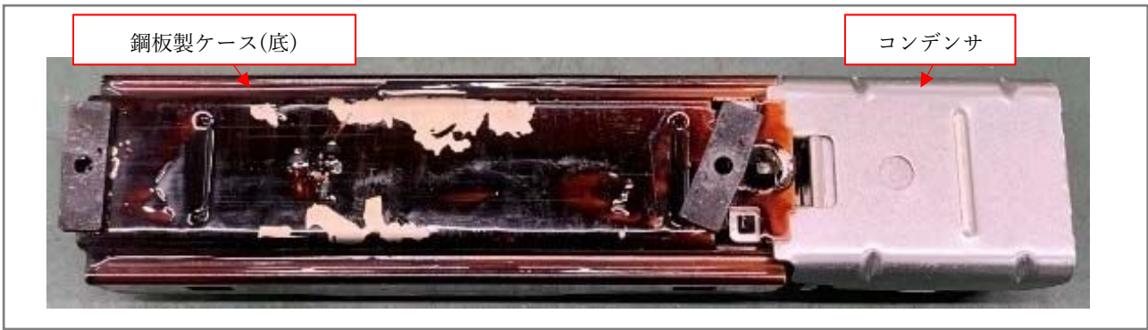
写真8：安定器外観（裏面）
