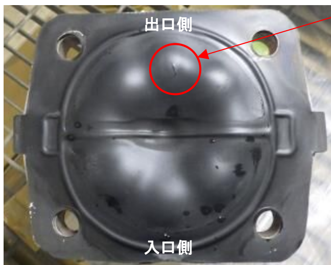
弁分解後ダイヤフラム外観 (接液側)
