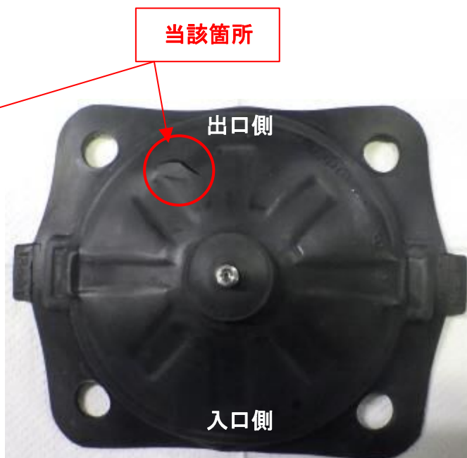
弁分解後ダイヤフラム外観 (非接液側)
