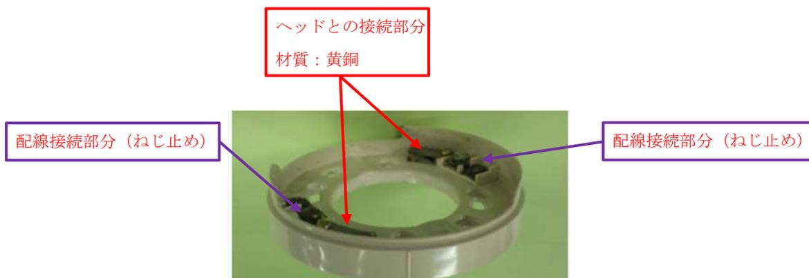
台座との接続は、ヘッドを回しながら取り付けすることで、台座の接続部分にヘッドの接続部分が挟みこまれる構造となっている。
