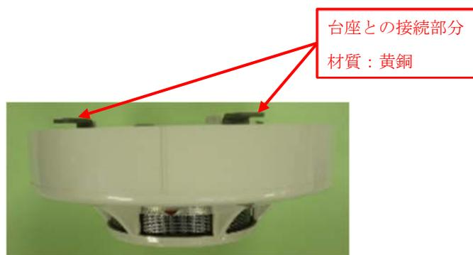
ヘッドは、台座と接続させるために回しながら取り付けることで、ヘッドの接続部分が台座の接続部分に挟み込まれる構造となっている。
