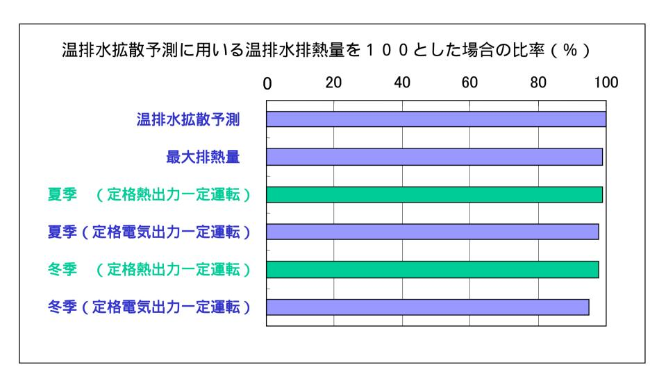
図 温排水排熱量の比較(概念図)
