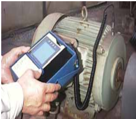
振動測定装置によるデータ採取
