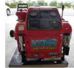
既存の可搬型消防ポンプ
