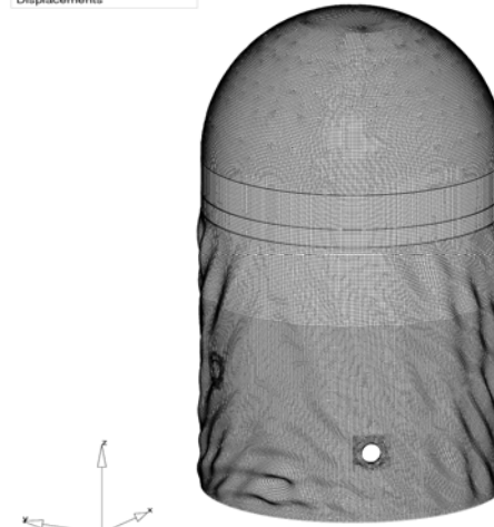
図 初期不整形状(EW方向、曲げ座屈)
