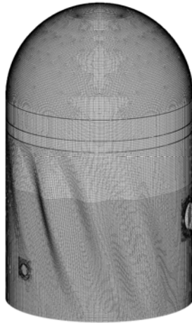
図 初期不整形状(EW方向、せん断座屈)
