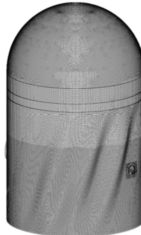
図 初期不整形状(EW方向、せん断座屈)
