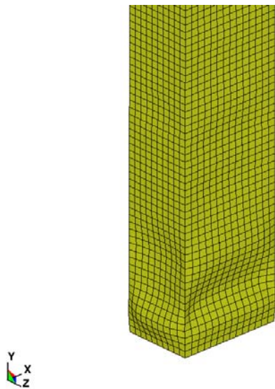
図 4. 6 衝突後の鋼製材変形図
