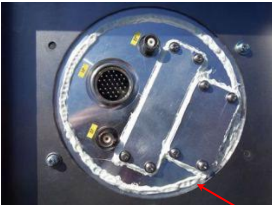
検出器底部のコーキング状況
