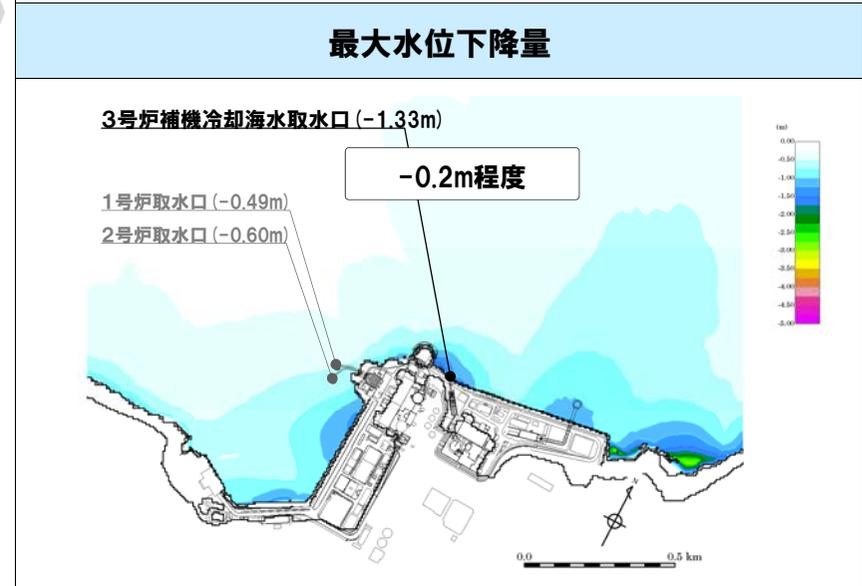
：3号炉敷地前面(上昇側)及び3号炉補機冷却海水取水口(下降側)における差分
