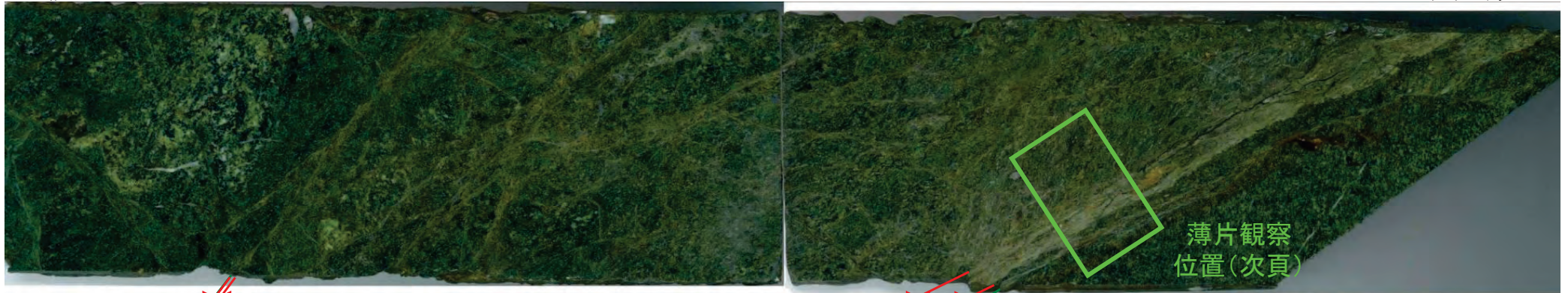
塩基性片岩 / 細粒部 / 塩基性片岩 / 破碎部 / 細粒部 / 塩基性片岩 / 5cm / 研磨片写真(平成26年撮影) (S)
