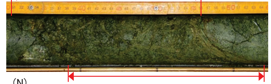
(N) N57~62° E/51~70° NW f4断層(深度約9m)コア写真 (平成26年撮影)
