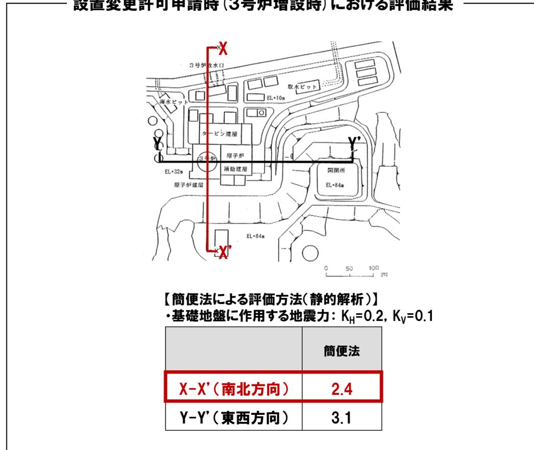
○X-X' 断面 (南北断面) のすべり安全率が厳しいことから、**X-X' 断面 (南北断面)** を評価断面として選定する。
