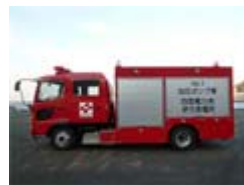
加圧ポンプ車
