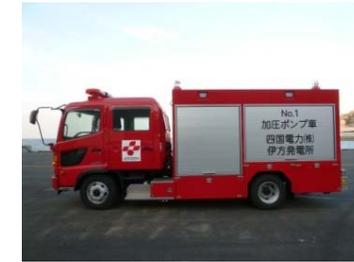
車両型SA設備(例:加圧ポンプ車)
