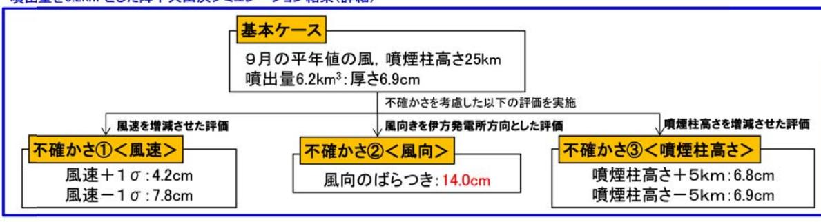
図33：降下火山灰シミュレーション (平成27年4月21日原子力安全専門部会資料1-1)
