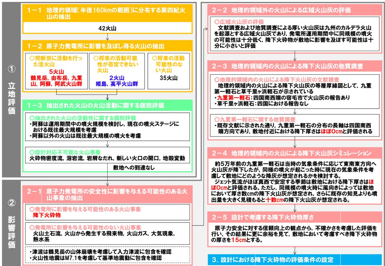
図 32 : 伊方発電所における火山影響評価結果の概要
