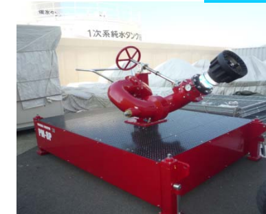
放水砲 (大型2台)
