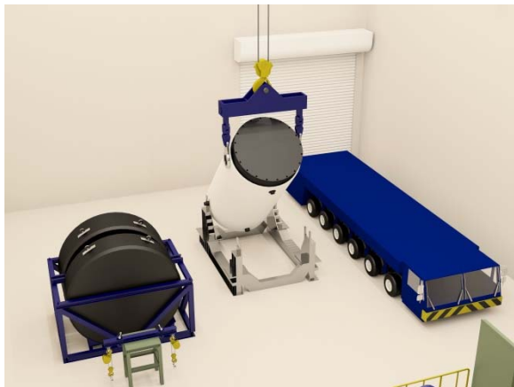
⑩横倒し、専用車両へ積み付け
