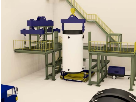
⑩横倒し、専用車両へ積み付け
