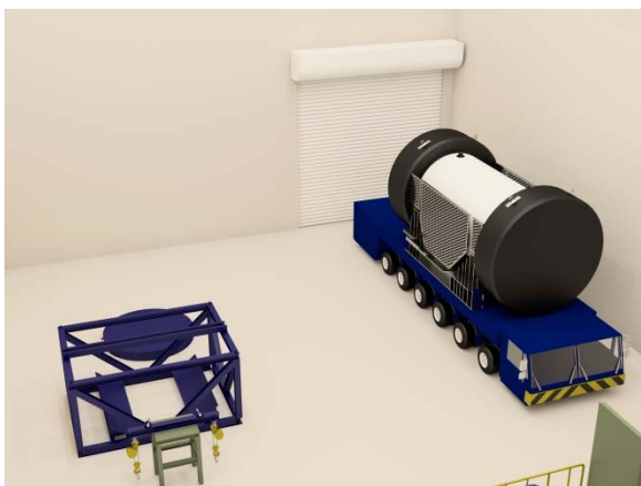
④専用車両で取扱エリアへ搬入
