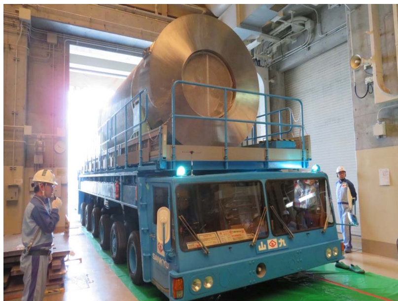
写真1 使用済燃料構内輸送の状況
