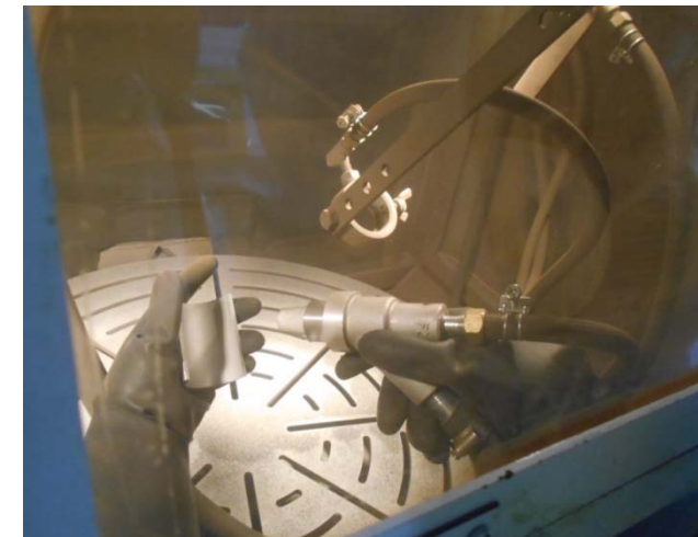
写真2 グローブボックス内でブラスト法による汚染の除去を実施中
