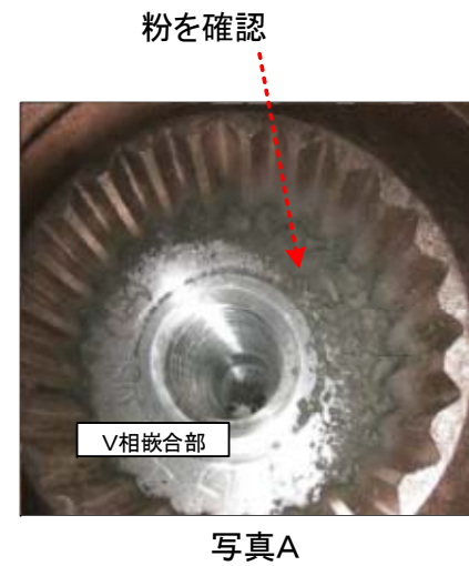
図14 伊方南幹線2号線乙母線断路器 内部確認結果
