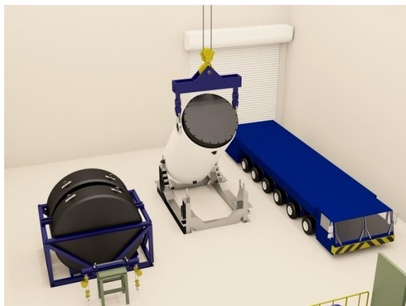
⑩横倒し、専用車両へ積み付け
