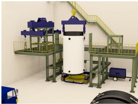
⑩横倒し、専用車両へ積み付け
