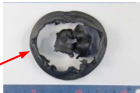
ガスケット劣化状況
