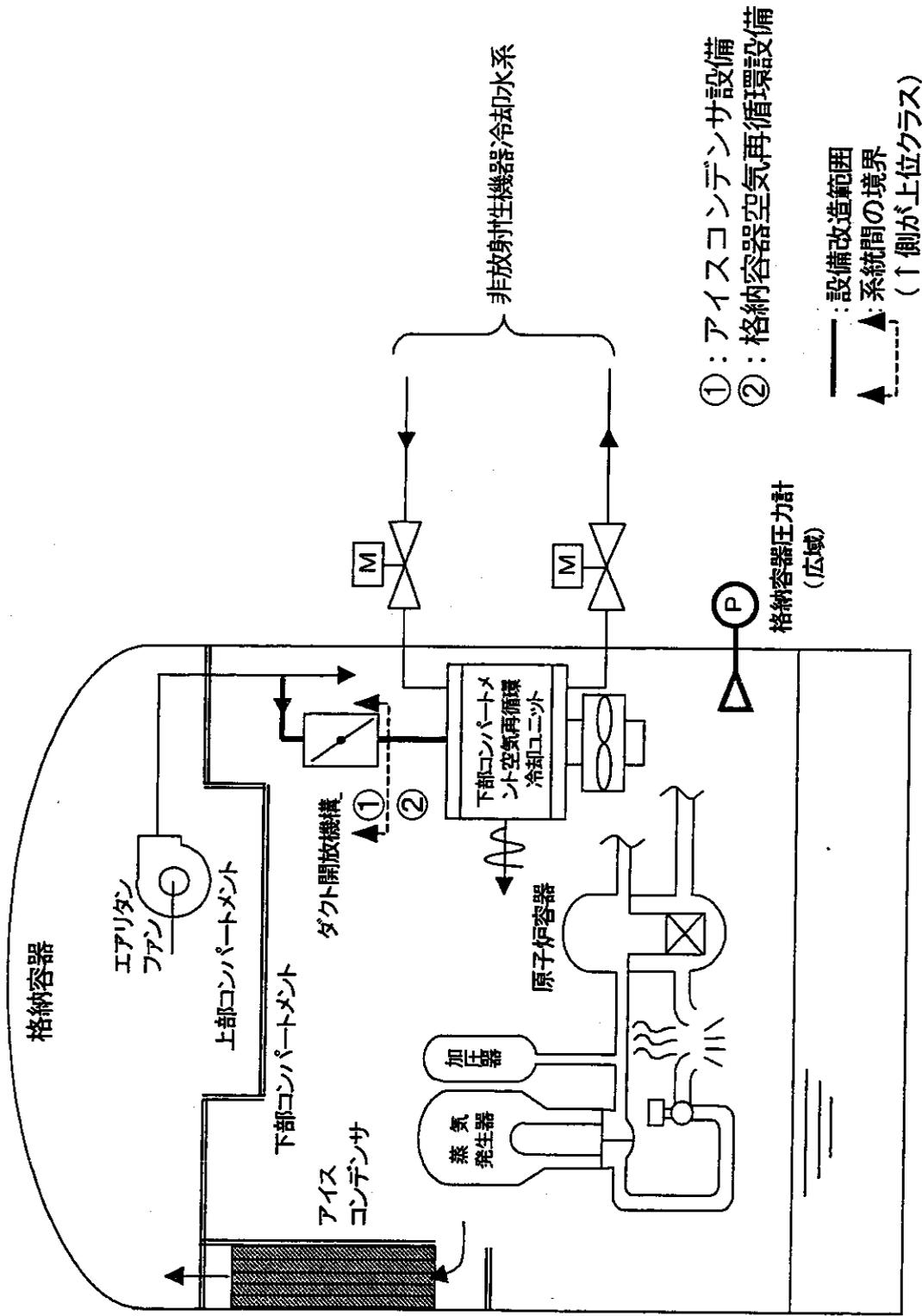
図 2.3-3 格納容器内自然対流冷却 (概念図) (アイスコンデンサ型 4 ループアラント)
