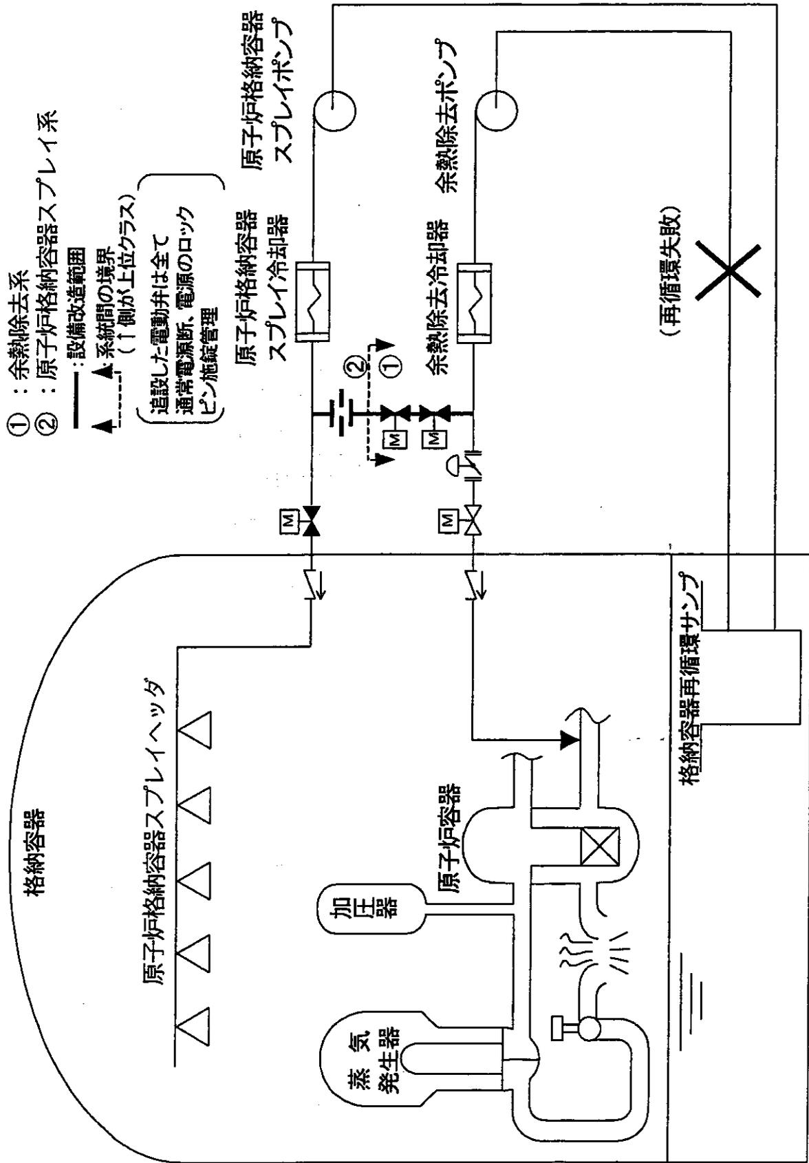
図 2.2-2 代替再循環 (概念図) (ドライ型3ループプラント)
