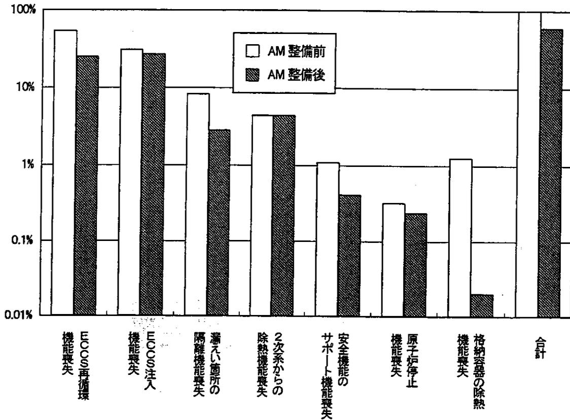
図 4.4-1 炉心の健全性に関するPSA(レベル1PSA)結果(ドライ型4ループプラント)
