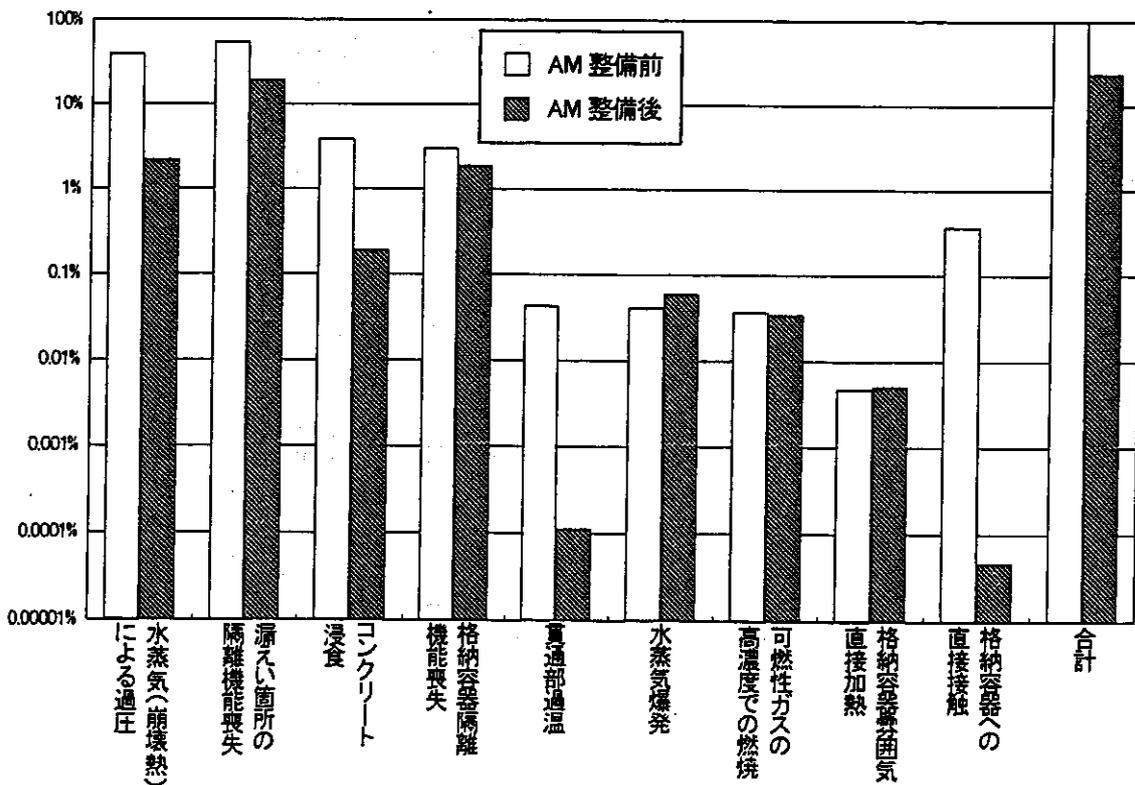
図 4.4-2 格納容器の健全性に関するPSA(レベル2PSA)結果(ドライ型4ループプラント)
