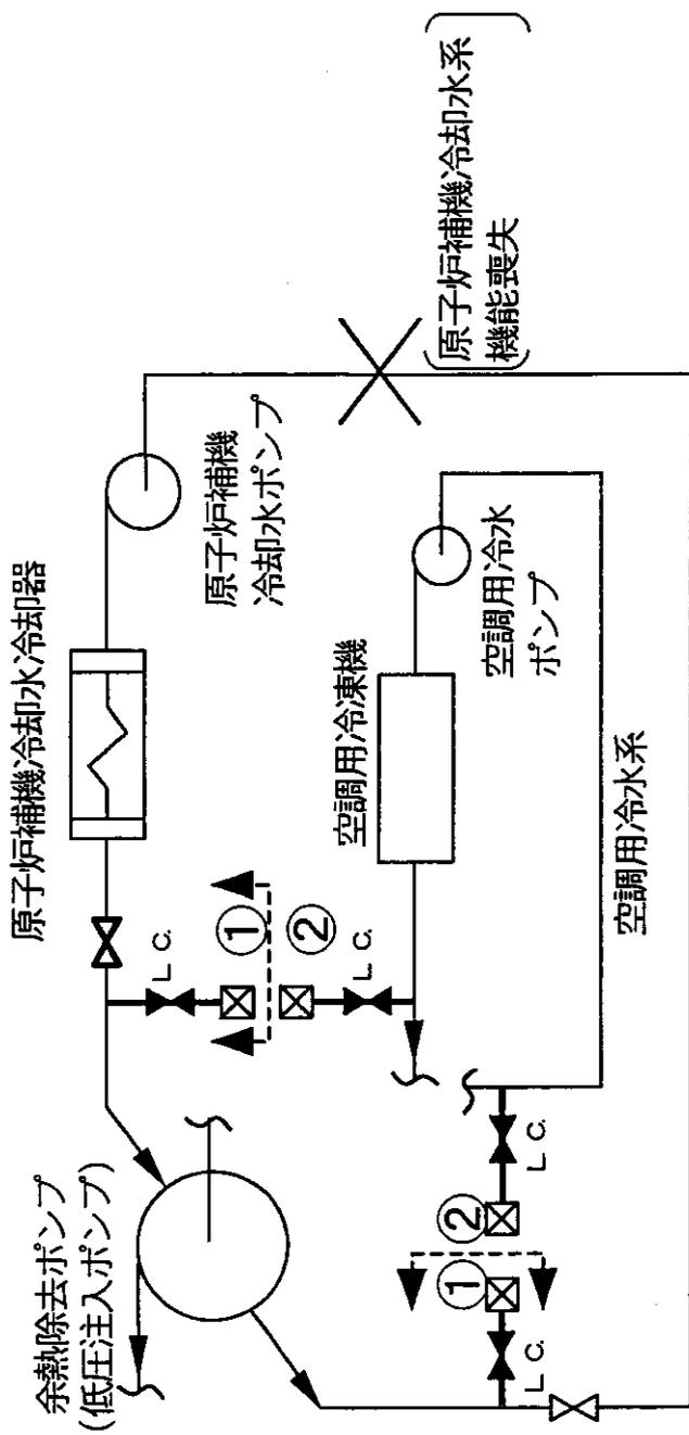
原子炉補機冷却水系
