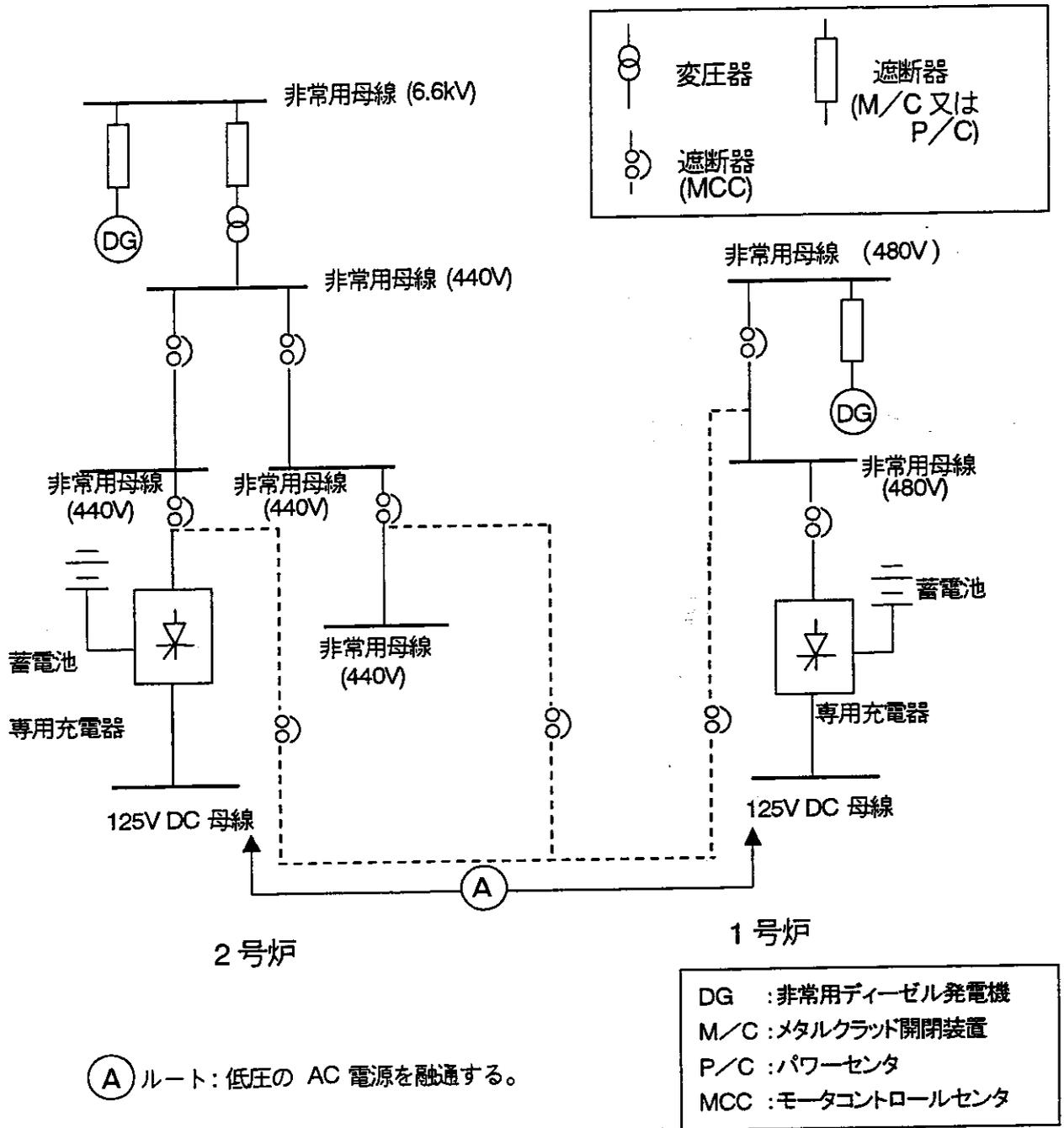
図 2.5-3 号機間電源融通 (概念図) (敦賀 2号炉)
