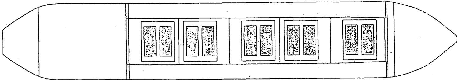
資料9 使用済燃料輸送専用船概観図(例)
