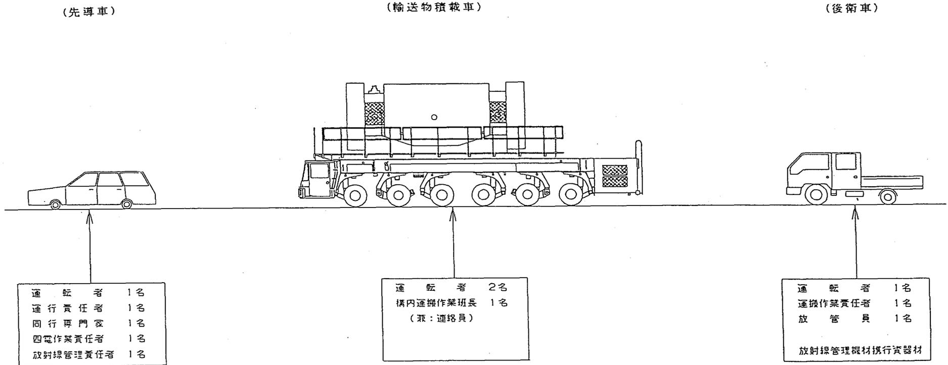
資料6 輸送物積載図 (NFT-14P型輸送物、伊方発電所側)(例)
