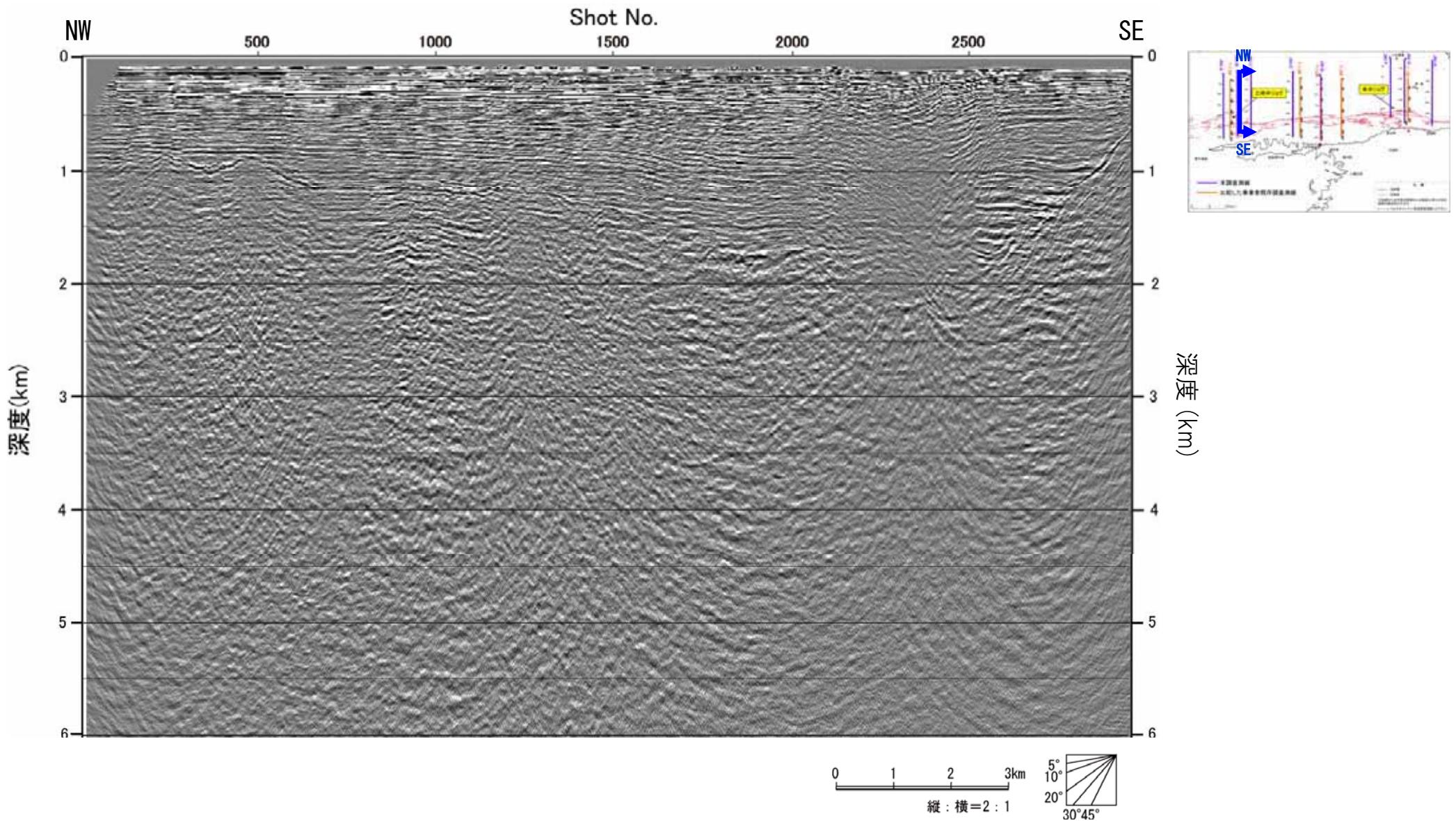
図-43 エアガンによる探査断面図 (JNI-B 深度断面)
