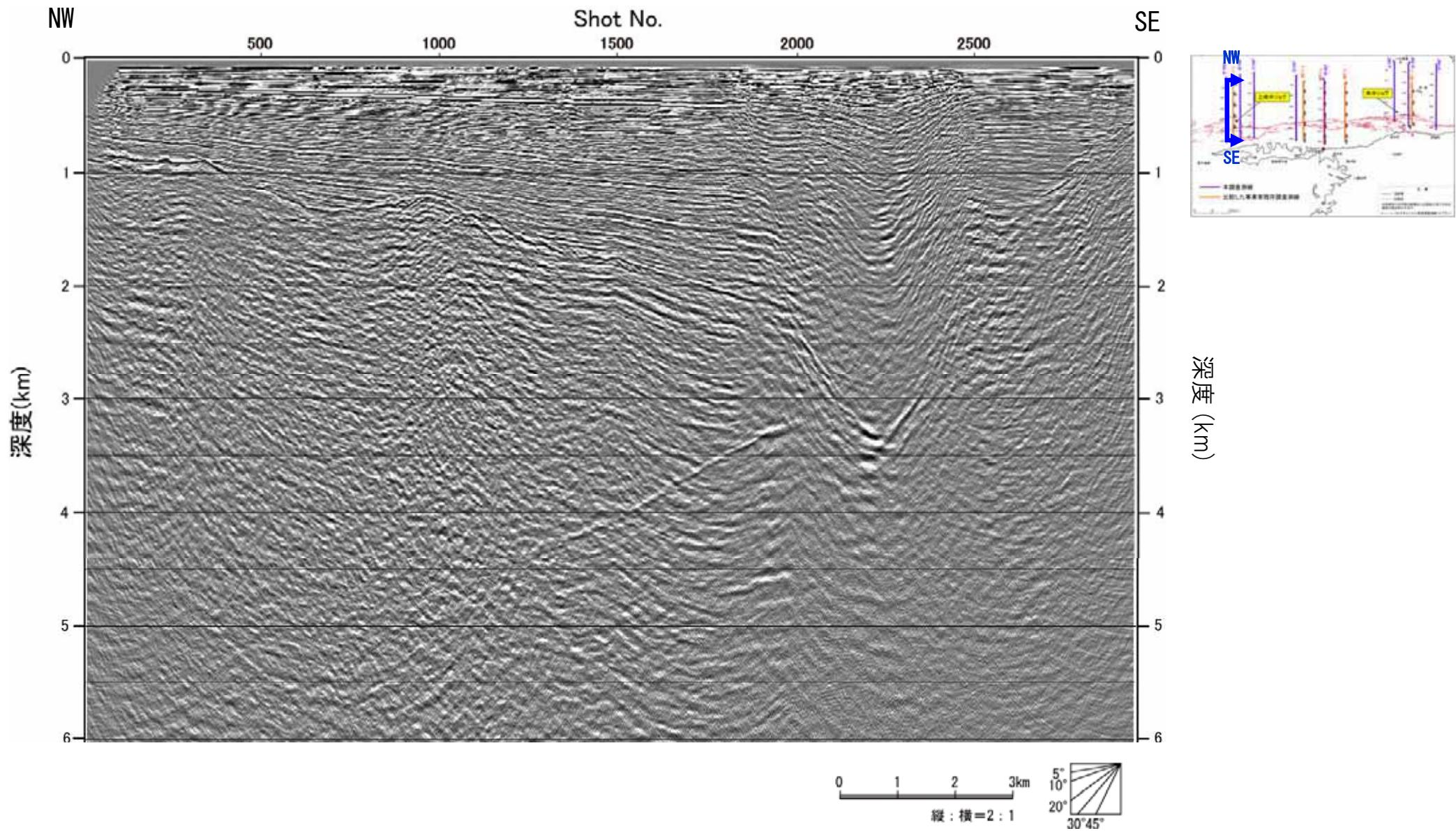
図-38 エアガンによる探査断面図 (JNI-A 深度断面)
