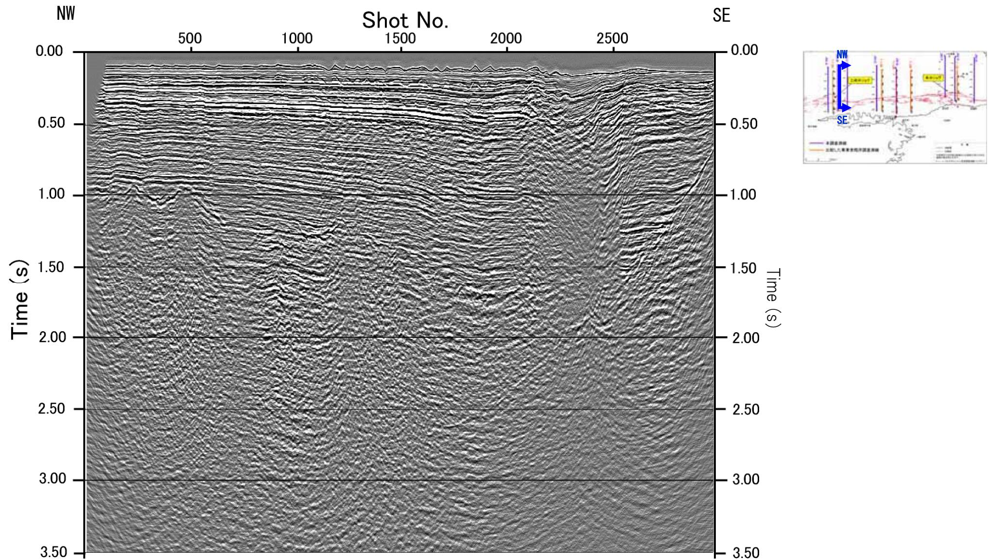
図-42 エアガンによる探査断面図 (JNI-B 時間断面)
