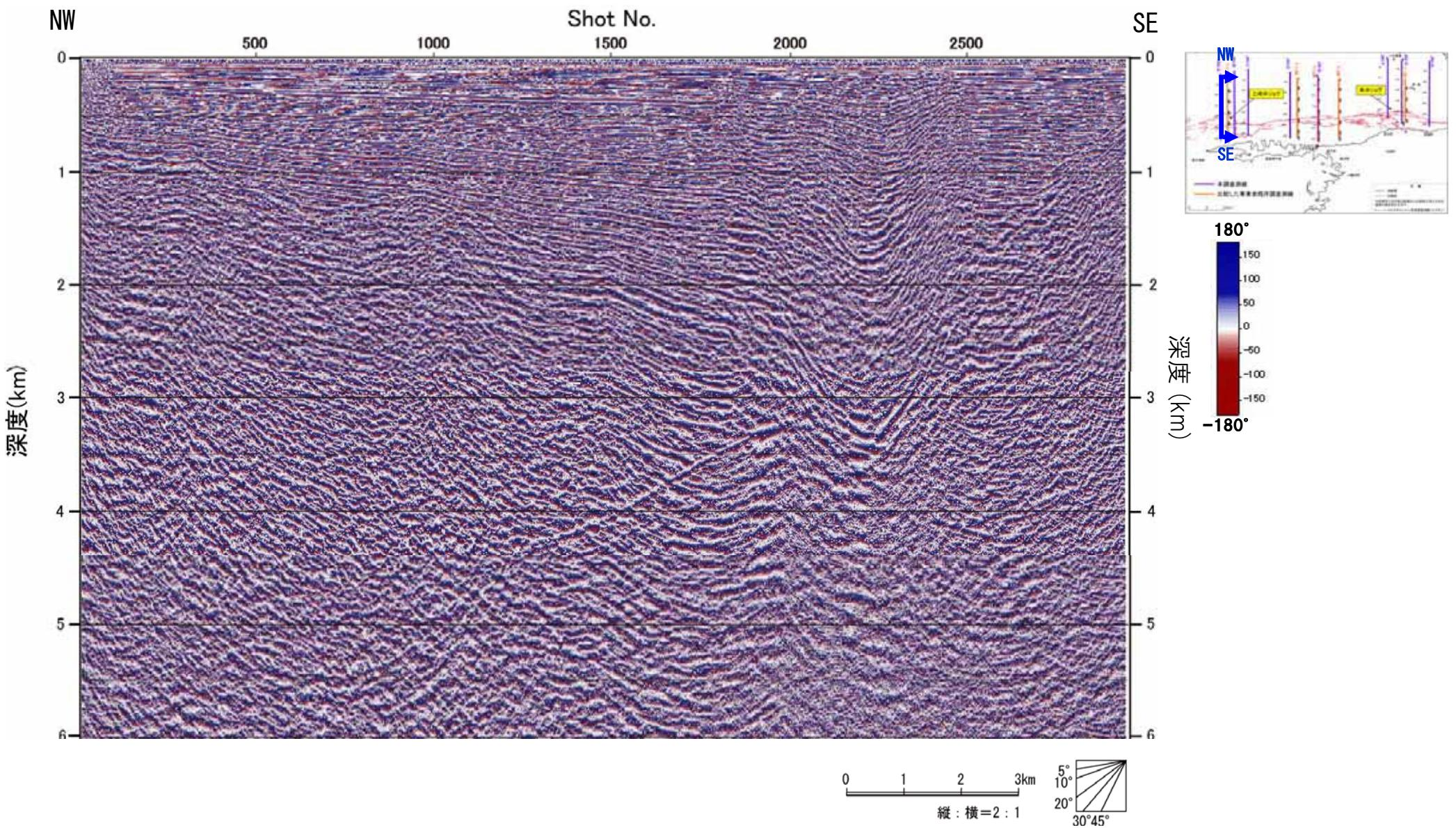
図-39 アトリビュート解析断面図 (JNI-A 瞬間位相)
