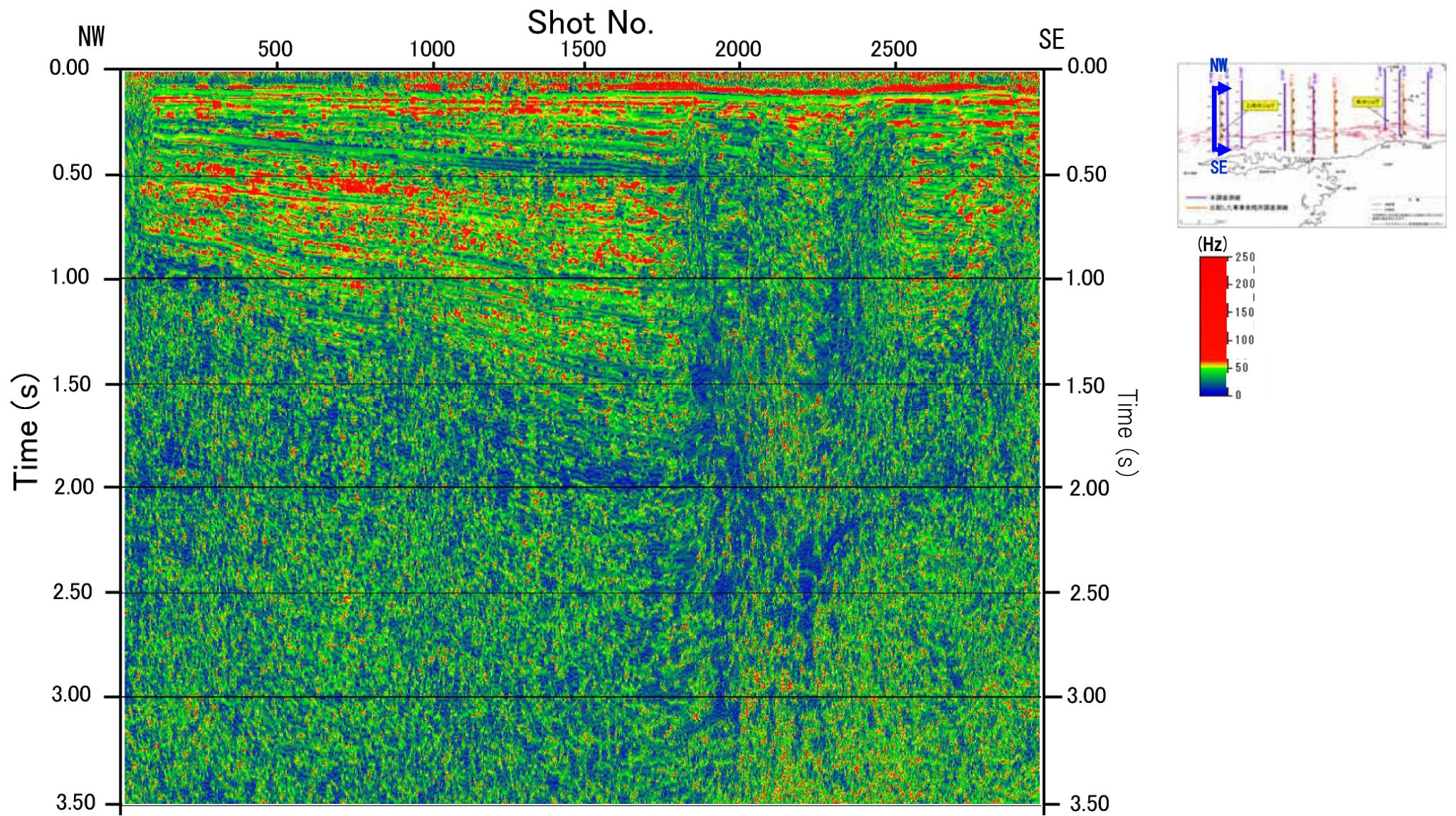
図-41 アトリビュート解析断面図 (JNI-A 瞬間周波数)
