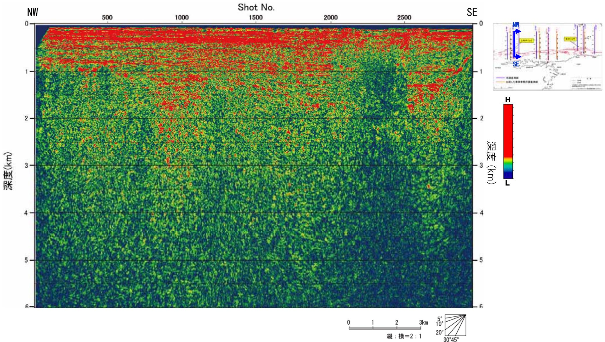
図-45 アトリビュート解析断面図 (JNI-B エンベロープ)
