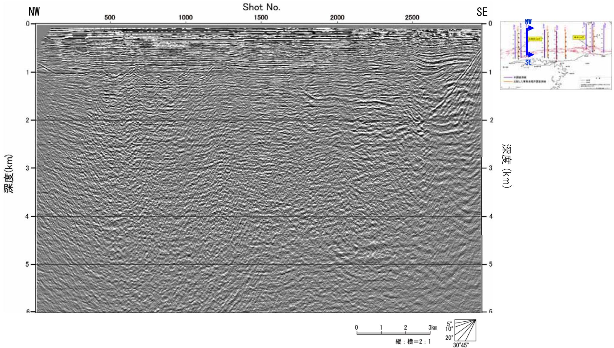
図-48 エアガンによる探査断面図 (JNI-C 深度断面)
