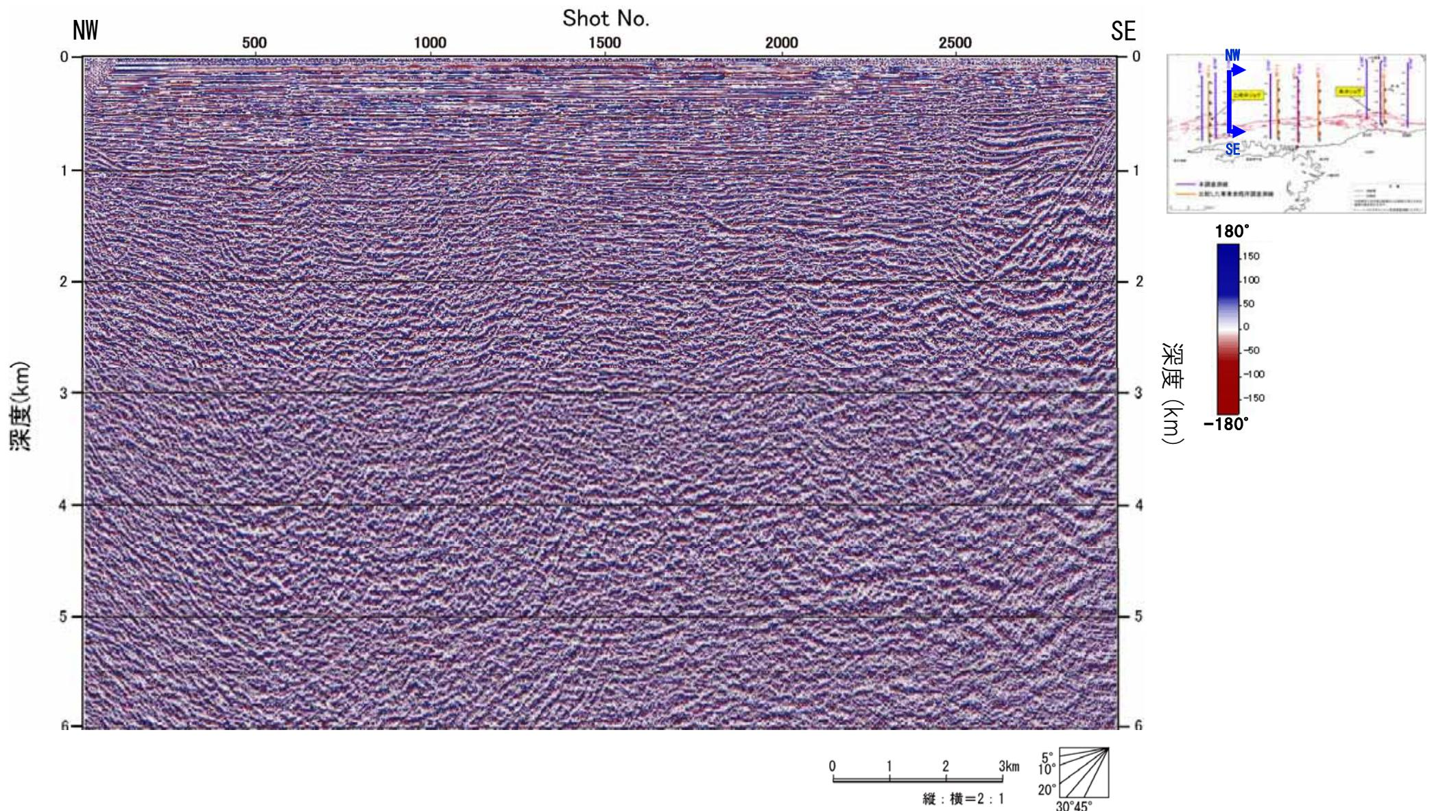
図-49 アトリビュート解析断面図 (JNI-C 瞬間位相)
