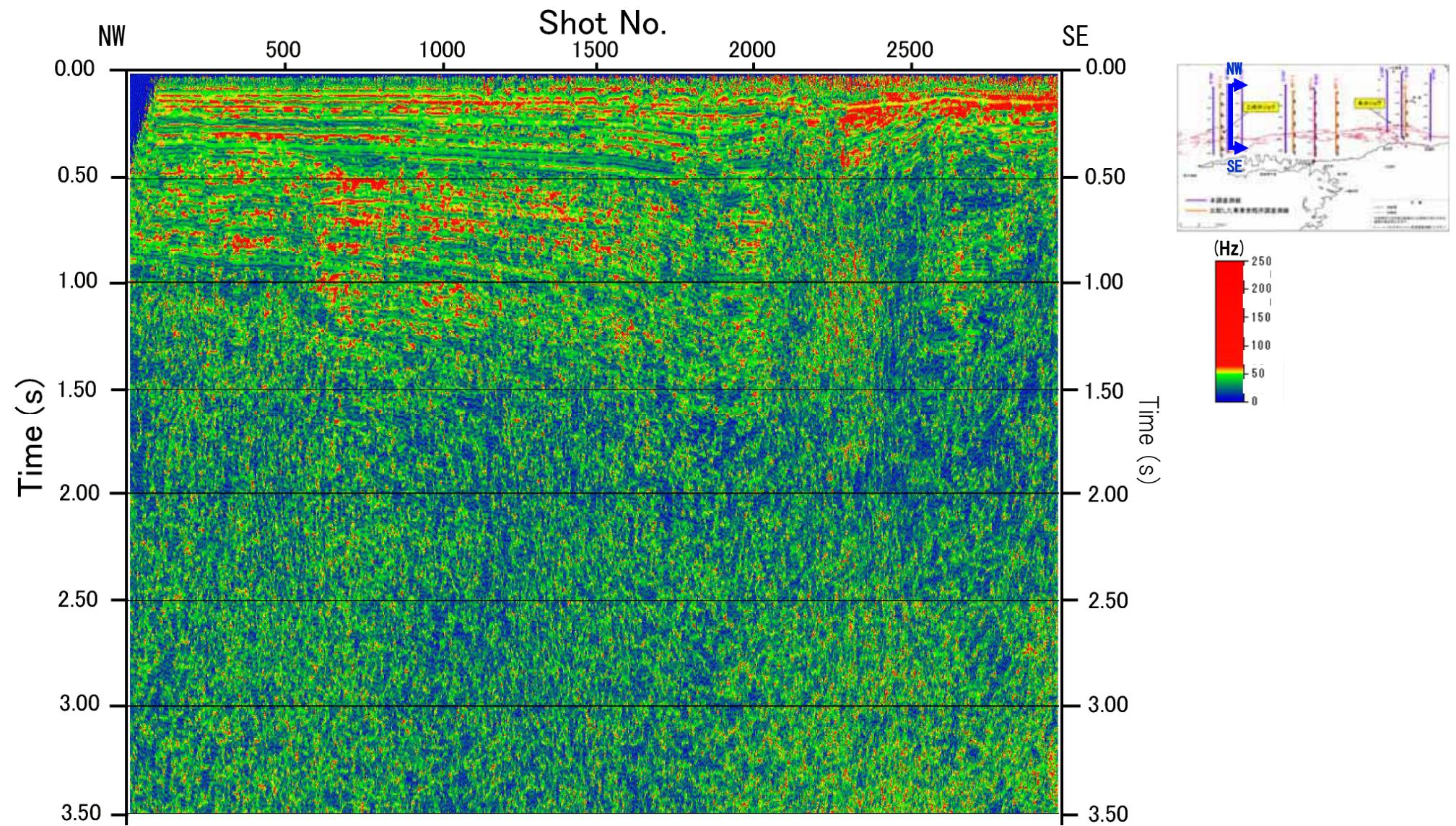
図-46 アトリビュート解析断面図 (JNI-B 瞬間周波数)
