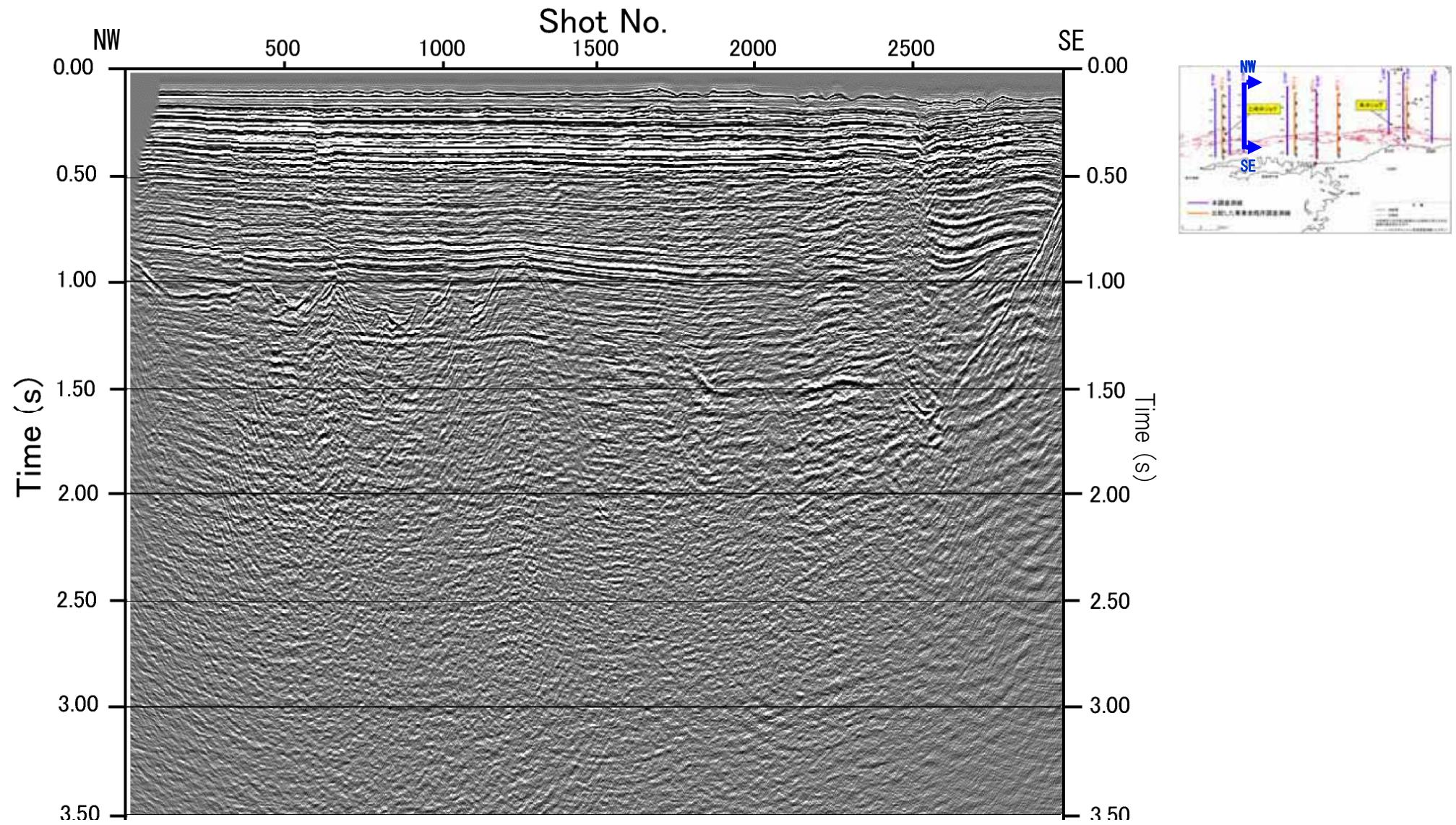
図-47 エアガンによる探査断面図 (JNI-C 時間断面)
