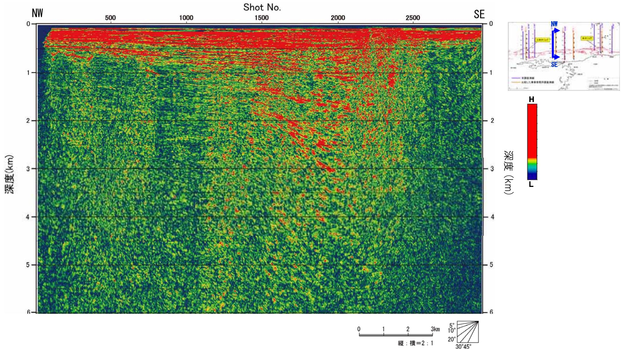
図-55 アトリビュート解析断面図 (JNI-D エンベロープ)
