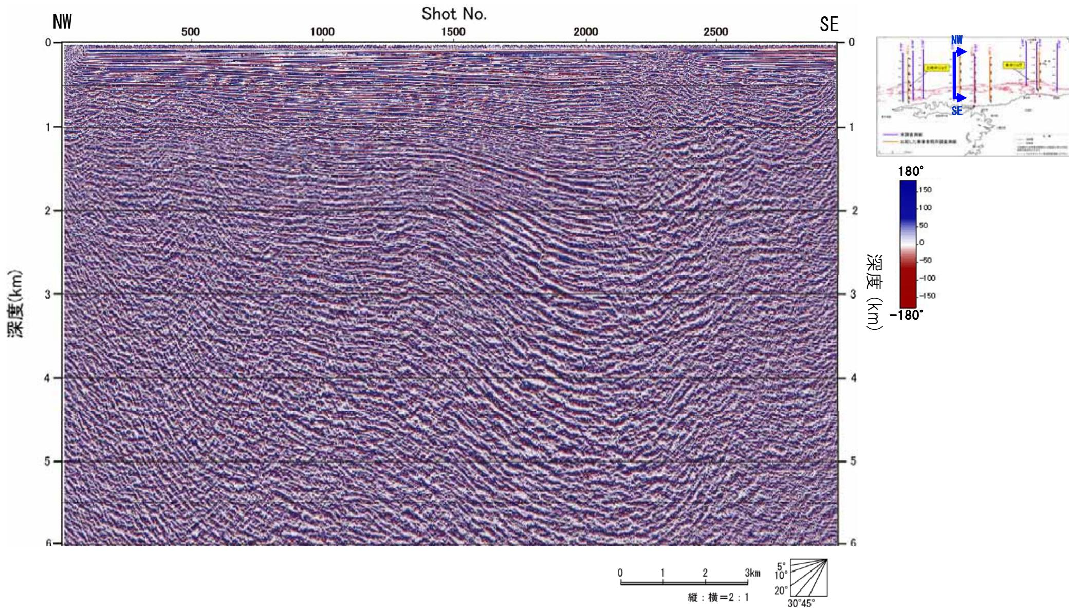
図-54 アトリビュート解析断面図 (JNI-D 瞬間位相)
