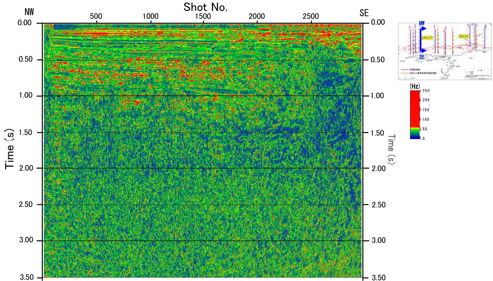
図-51 アトリビュート解析断面図 (JNI-C 瞬間周波数)
