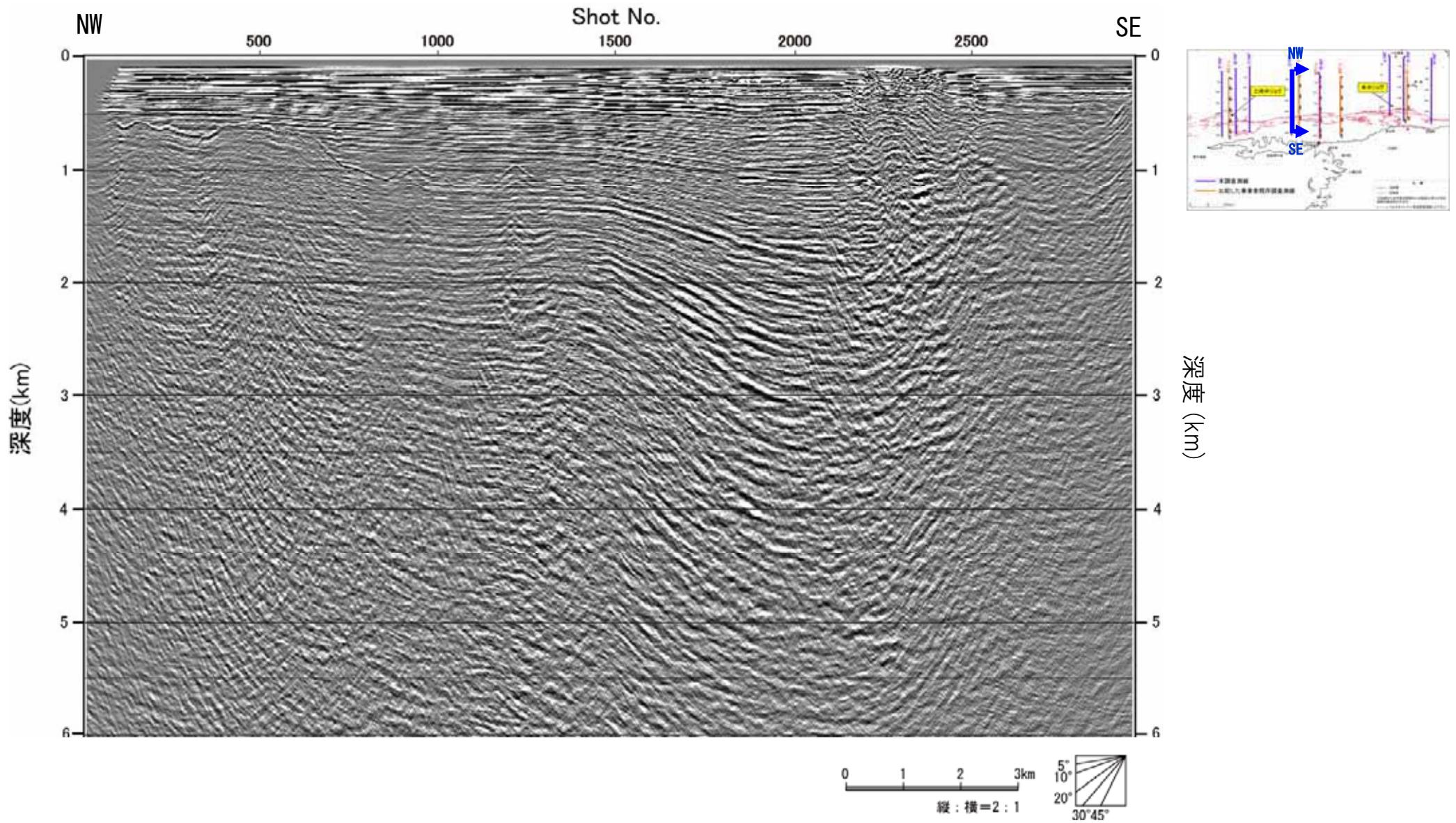
図-53 エアガンによる探査断面図 (JNI-D 深度断面)
