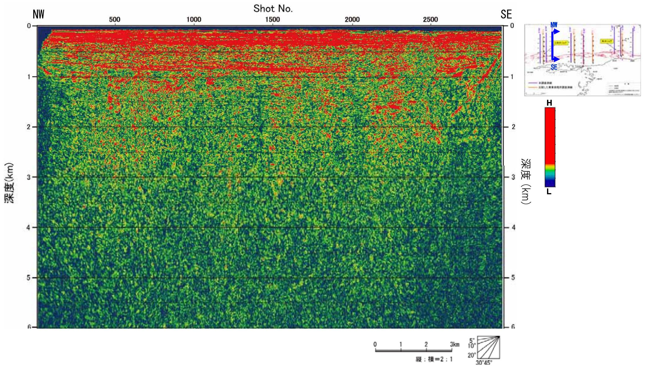
図-50 アトリビュート解析断面図 (JN1-C エンベロープ)
