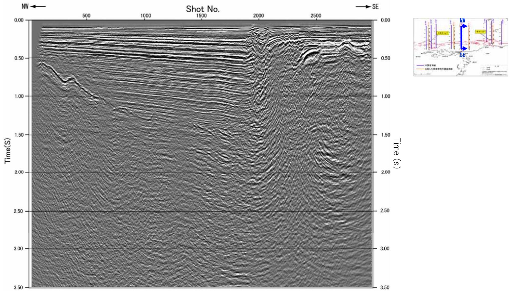
図-57 エアガンによる探査断面図 (JNI-E 時間断面)
