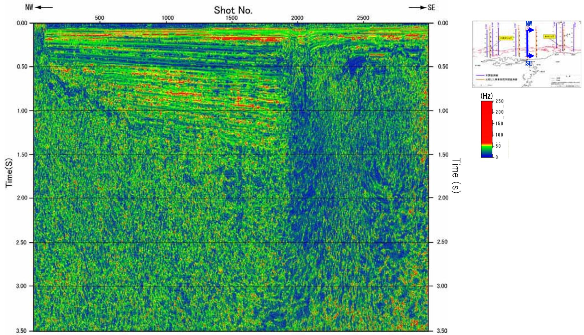
図-61 アトリビュート解析断面図 (JNI-E 瞬間周波数)
