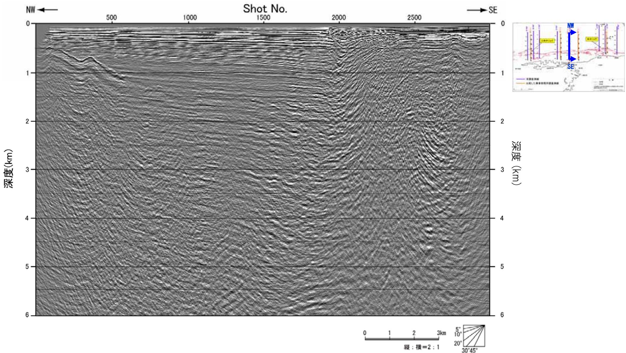
図-58 エアガンによる探査断面図 (JNI-E 深度断面)
