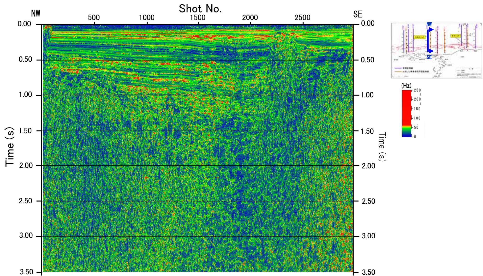
図-56 アトリビュート解析断面図 (JNI-D 瞬間周波数)
