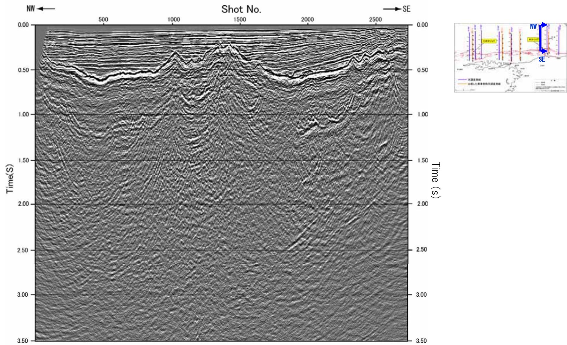
図-62 エアガンによる探査断面図 (JNI-F 時間断面)
