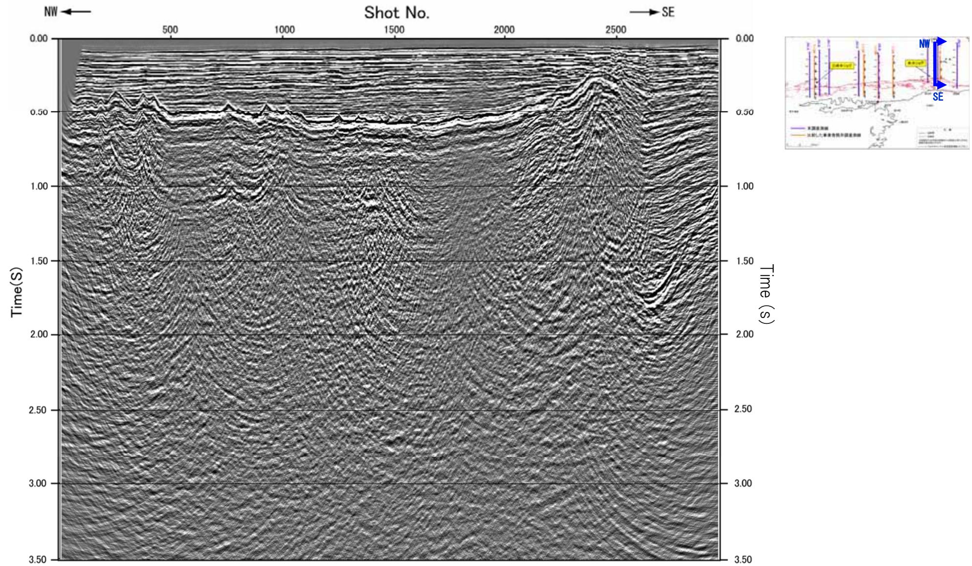
図-67 エアガンによる探査断面図 (JN1-G 時間断面)
