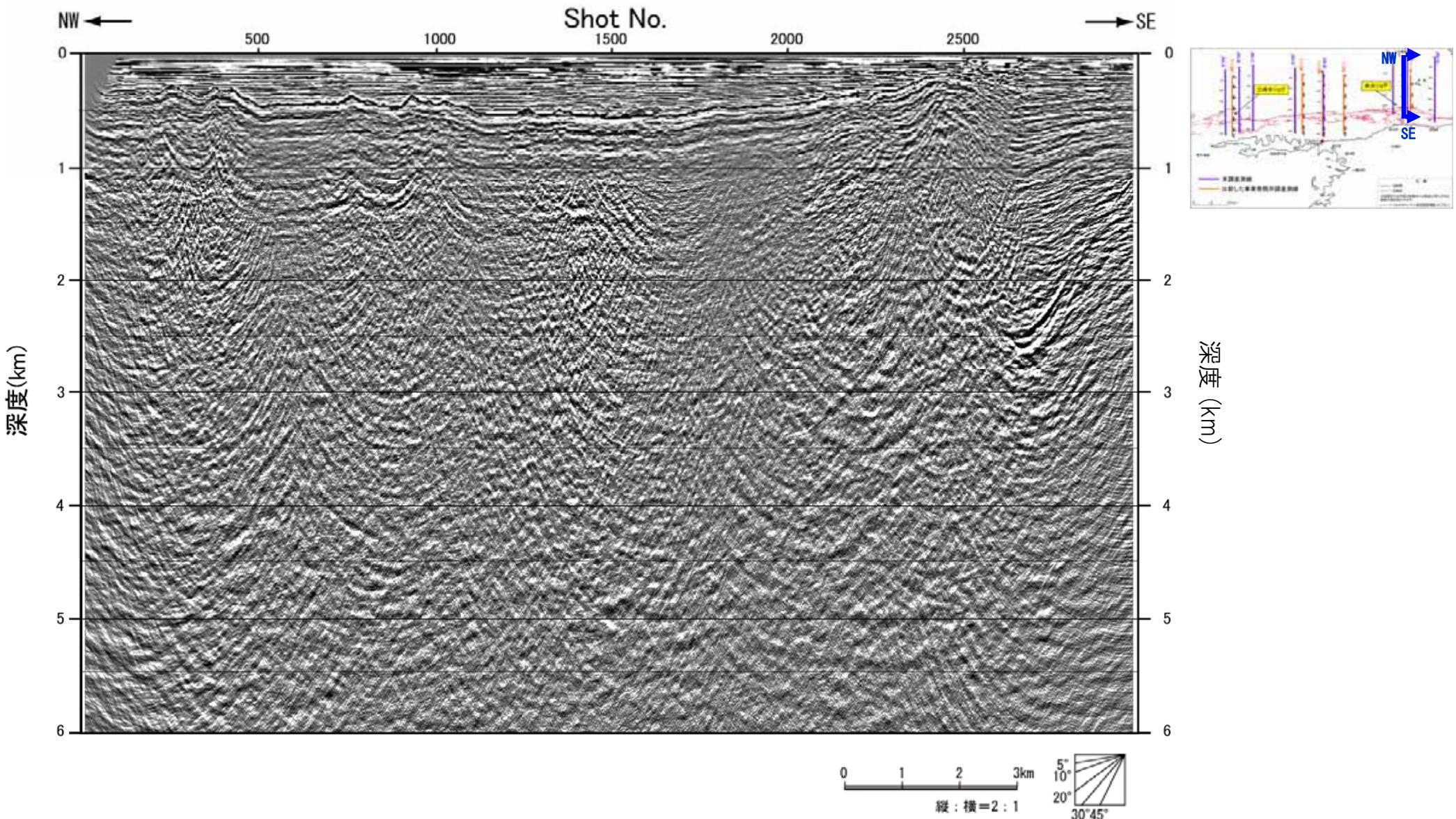
図-68 エアガンによる探査断面図 (JN1-G 深度断面)
