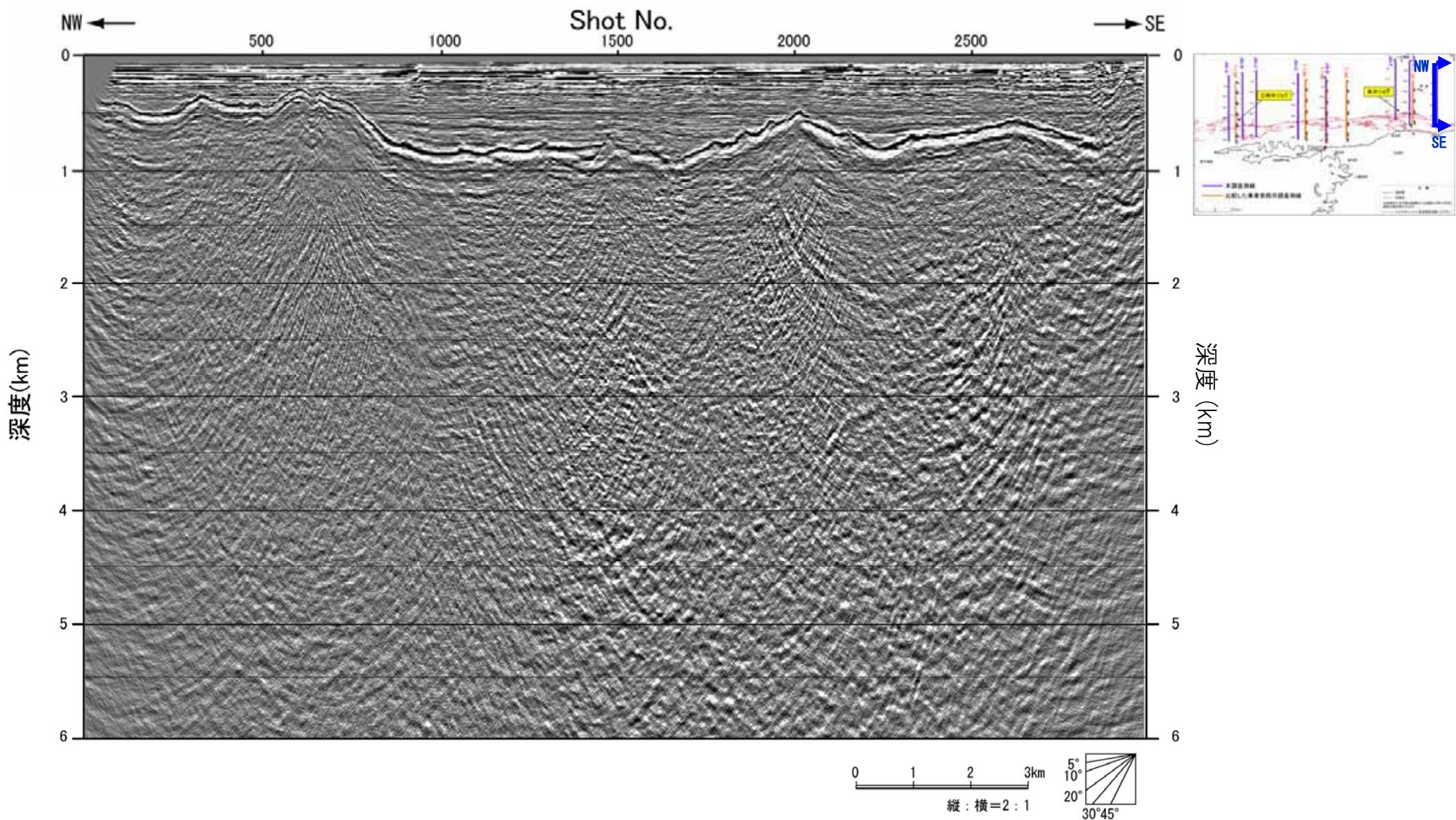
図-73 エアガンによる探査断面図 (JNI-H 深度断面)
