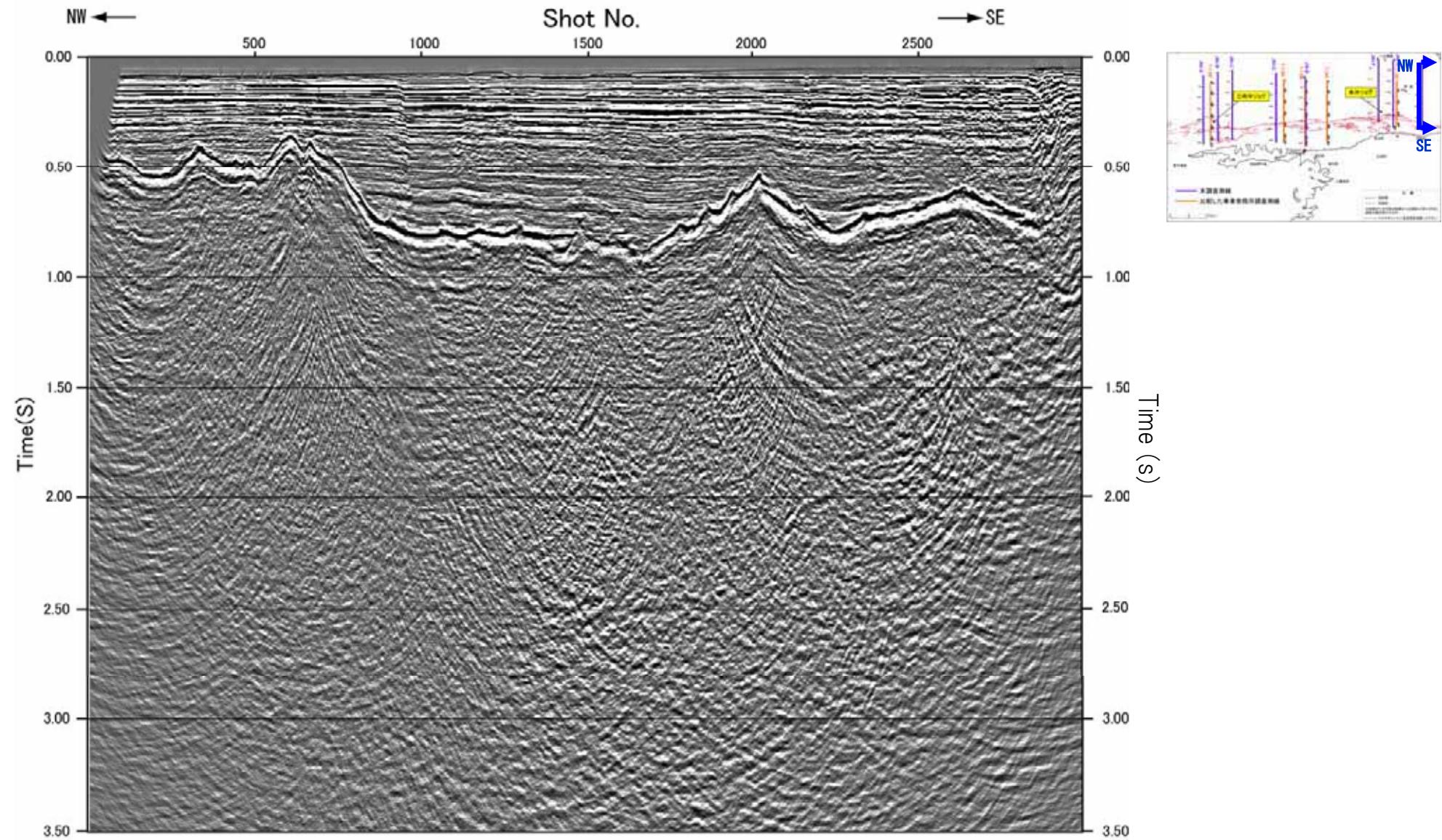
図-72 エアガンによる探査断面図 (JNI-H 時間断面)
