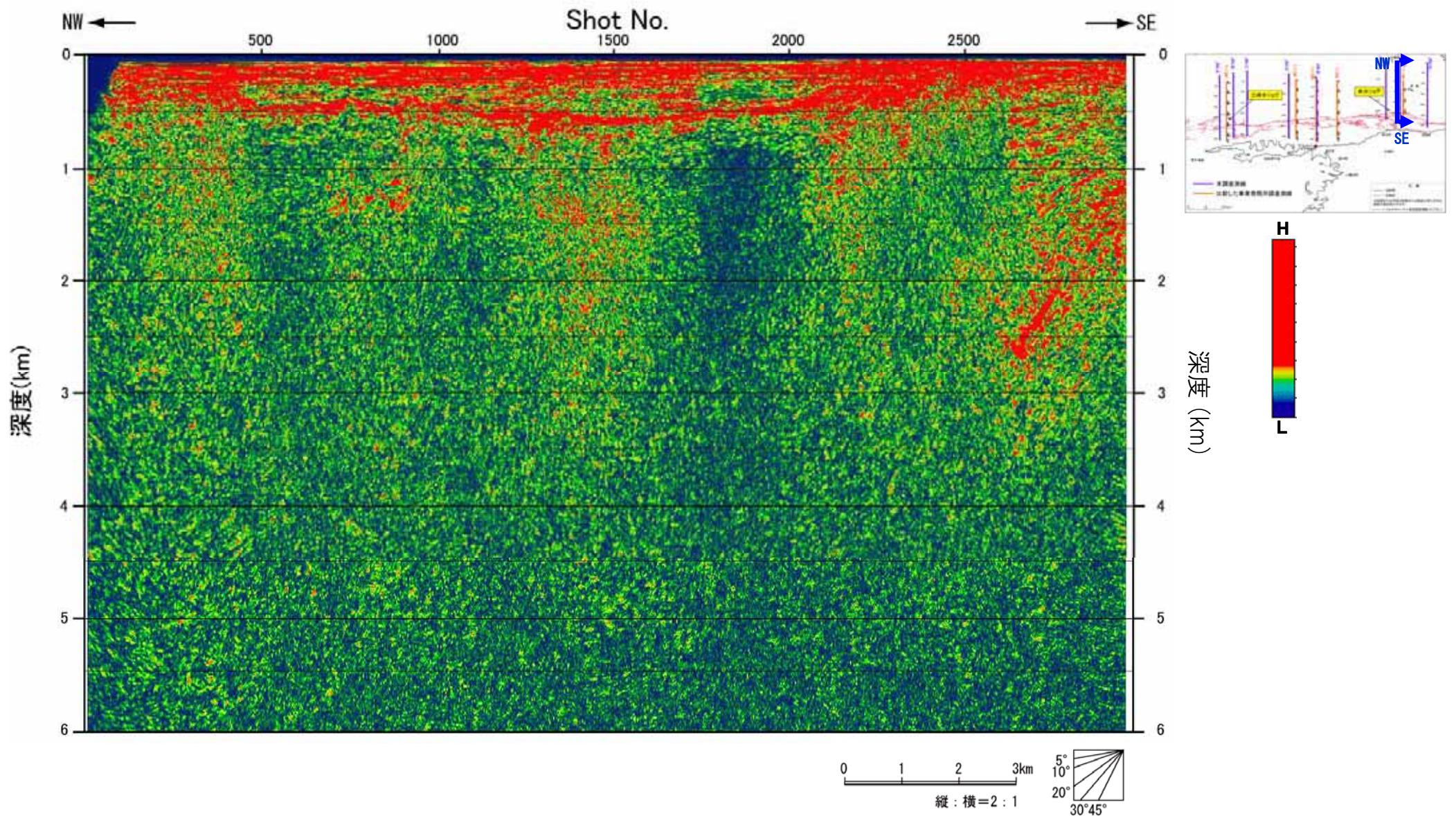
図-70 アトリビュート解析断面図 (JNI-G エンベロープ)
