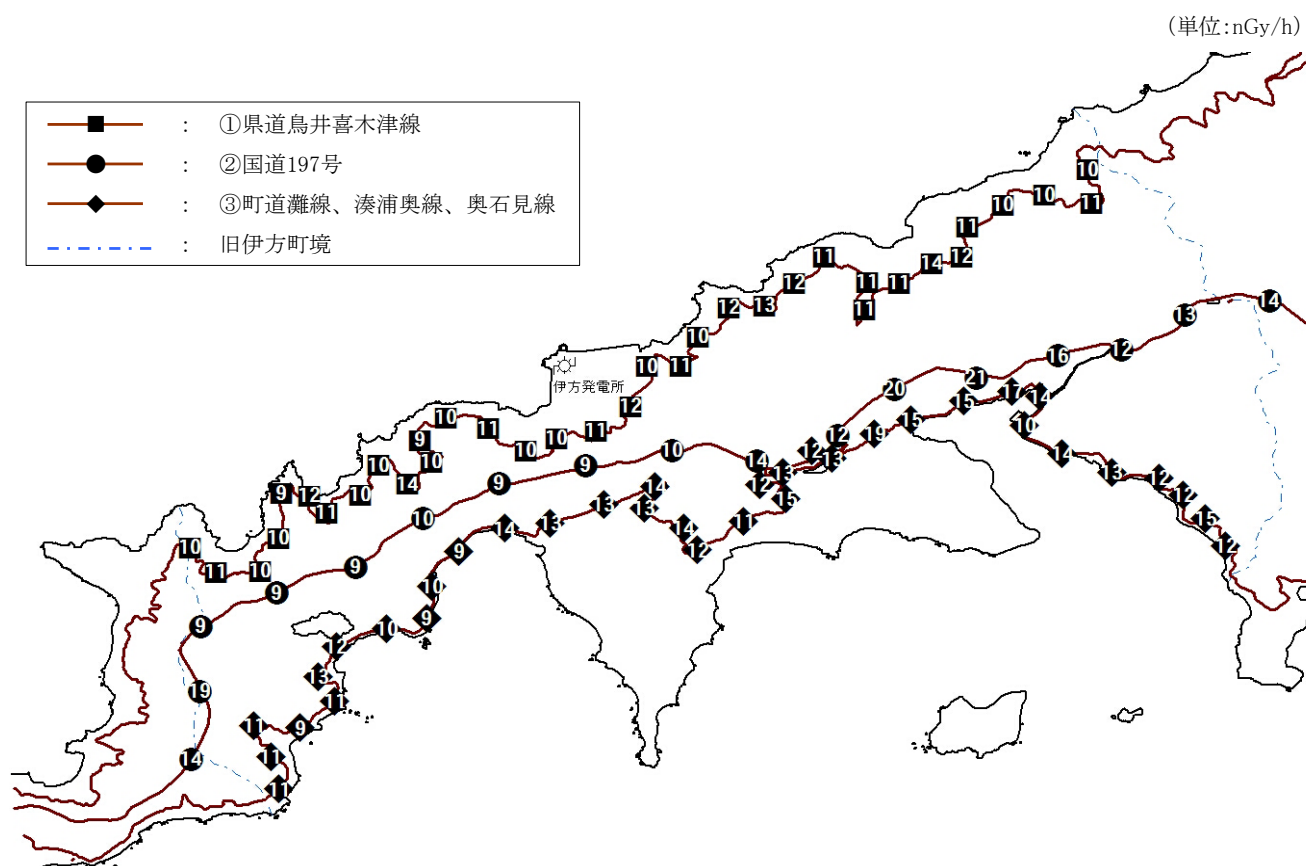
図1-1 3"φ×3"NaI(Tl)シンチレーション検出器(エネルギー補償方式)による測定結果
